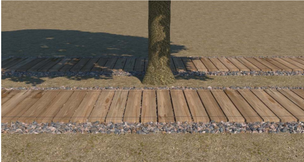
Plataformes per a zones de pas massiu o constant de gent o vehicles amb taulons de fusta i llit de grava
