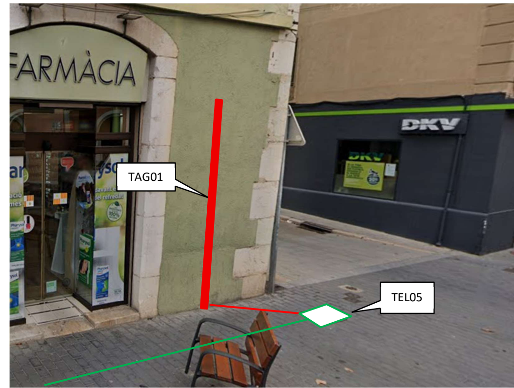
• Il·lustració 50: Nova canalització de tipus 1c63 entre el pericó TEL05 i el tub TAG01
