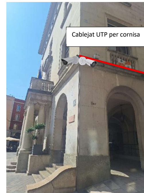
Il·lustració 53 Cablejat des del PdC-6 cap a l'interior
